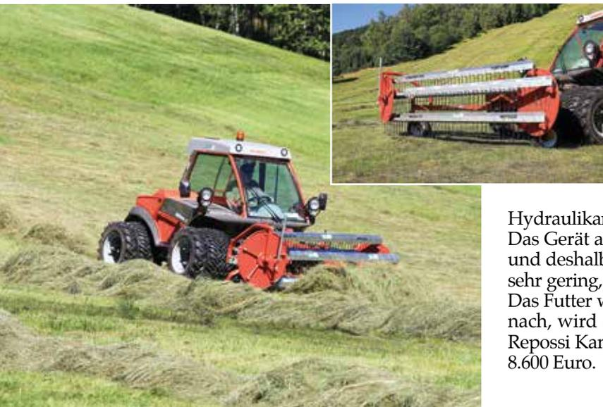
Repossi hat am alten System des Schubrechenwenders festgehalten und baut heute diese Technik unter dem Begriff Kammschwader. Der verstärkte Fokus auf hohe Grundfutterqualität verschafft dieser Technik Auftrieb. Repossi baut 25 verschiedene Modelle von 2,5 bis 8 m Arbeitsbreite. Das Handling der Maschine ist vergleichbar mit einem Bandrechen. Die Haspel wird hydraulisch angetrieben, dafür braucht es rund 30 l Öl/min. Die kommen entweder vom Trägergerät oder aus der eigenen
